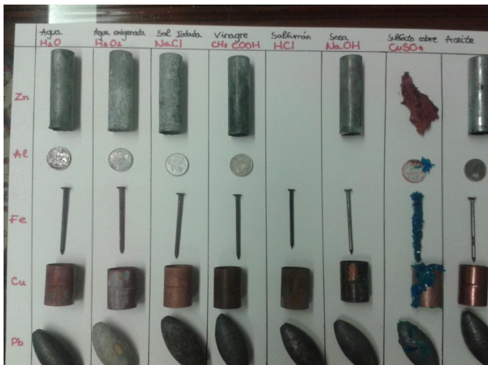
Figura 17: Metales tras 12 días de oxidación provocada
