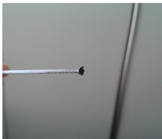
Figura 18: Corrosión del hierro en ácido clorhídrico.
