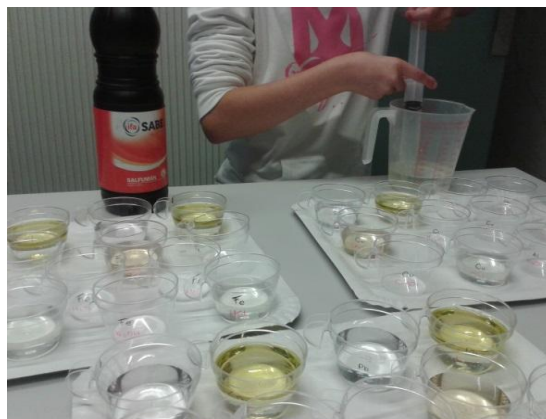
Figura 14: Uso de la jeringuilla para cuantificar los componentes líquidos necesarios para elaborar los reactivos que provocan la oxidación de los metales.
