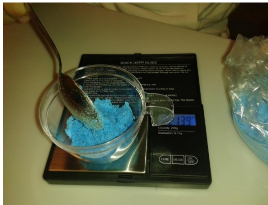
Figura 13: Uso de la báscula de precisión para cuantificar los componentes sólidos necesarios para elaborar los reactivos que provocan la oxidación de los metales.
