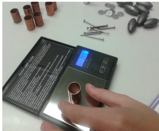
Figura 16: Medición de las variaciones de masa de las muestras de metal en una báscula de precisión.
