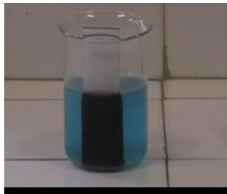
Figura 1: Oxidación del zinc en sulfato de cobre.
